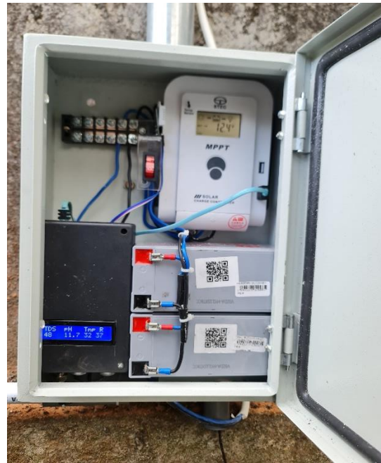
Gambar 7. Tampilan Alat Monitoring Kualitas Air Kolam Berbasis IoT .
