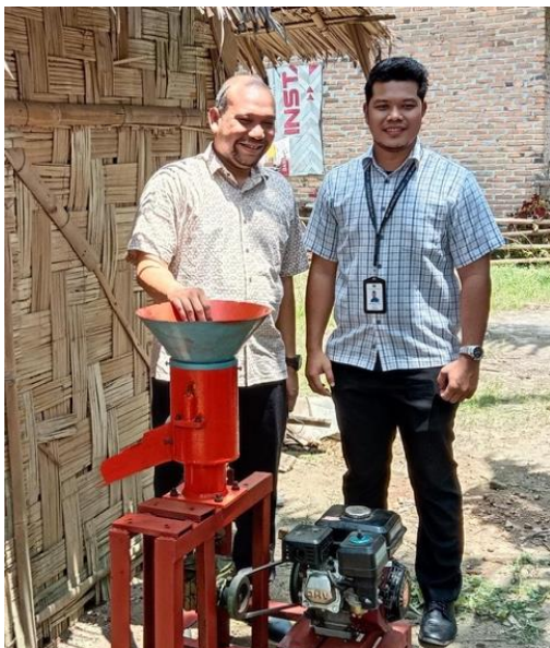
Gambar 6. Mesin Penggiling dan Pencetak Pelet
