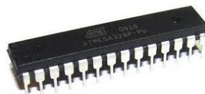
**Gambar 9. Mikrokontroler ATmega328**
