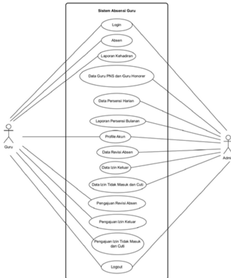
Gambar 2. Use Case Diagram Sistem yang Diusulkan
