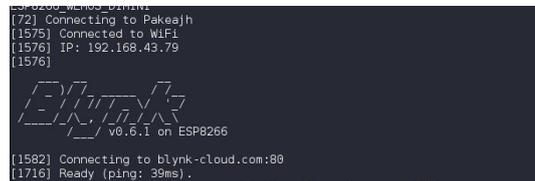
**Gambar 11.** Wemos D1 Mini ESP8266 Terhubung ke *Access Point*
