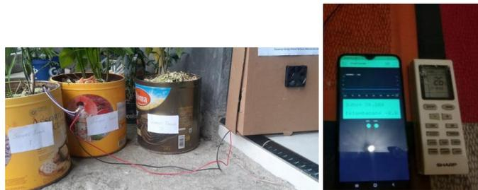
**Gambar 10.** Pemasangan Sensor Kelembaban Tanah dan Pengujian Sensor Suhu Terhadap Alat Ukur Pemanding
