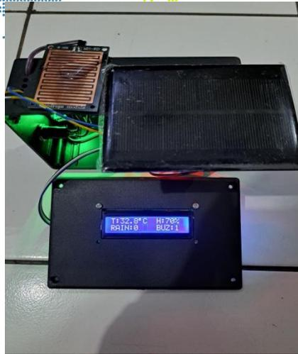
**Gambar 8.** Hasil Pengujian Raindrops Sensor
