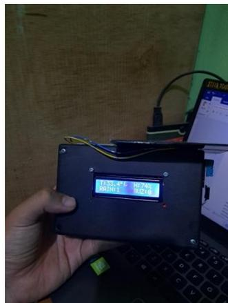
**Gambar 12.** Rancangan Prototype Alat Sensor Hujan di lingkungan rumah
