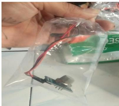
**Gambar 13.** Pemasangan sensor MQ-135 terhadap sampel
