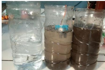
**Gambar 12.** Pemasangan sensor Turbidity terhadap 3 Sampel
