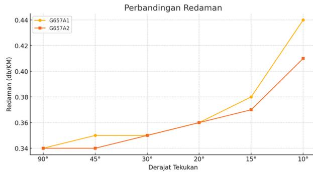
**Gambar 3.** Diagram Parameter Redaman Dengan Perlakuan Tekukan
