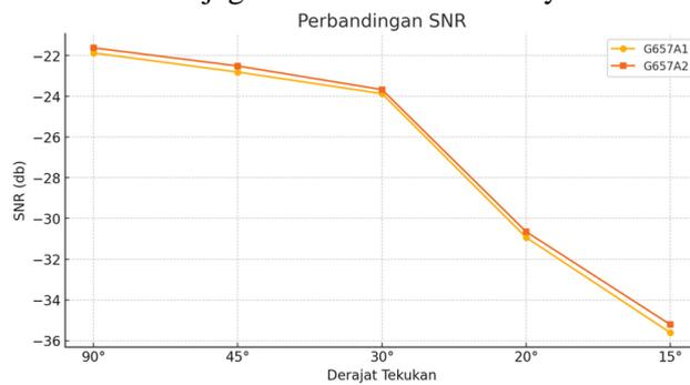
**Gambar 4.** Diagram Parameter SNR Dengan Perlakuan Tekukan
