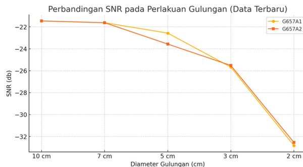
**Gambar 7.** Diagram Parameter SNR Dengan Perlakuan Gulungan
